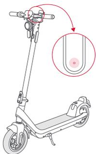
**04** Asegure los tornillos de ambos lados, de forma alternada, con la llave hexagonal de la caja del paquete (par de apriete: 4~5N\*m), y habrá terminado el ensamblado.
