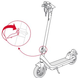
**02** Conecte el manubrio al conector de la línea principal del tubo vertical, e instale el manubrio en el tubo vertical.
