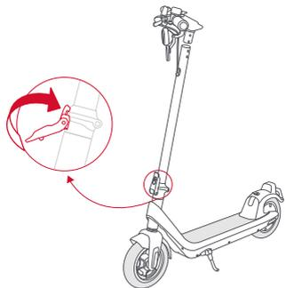
**02** Connectez le guidon au connecteur de la ligne principale du tube vertical, et installez le guidon sur le tube vertical.
