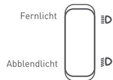
**Fernlicht/Ablendlicht:** Drücken Sie oben auf den Schalter, um das Fernlicht einzuschalten; drücken Sie den Schalter nach unten, um das Ablendlicht umzuschalten.
