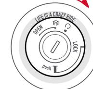
Inserire la chiave e portare il commutatore di accensione in posizione "BLOCCATO" per bloccare il manubrio dello sterzo
