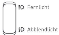
**Fernlicht/Abblendlicht:** Drücken Sie den Schalter nach rechts, um auf Fernlicht zu schalten; drücken Sie den Schalter nach links, um auf Abblendlicht zu schalten.
